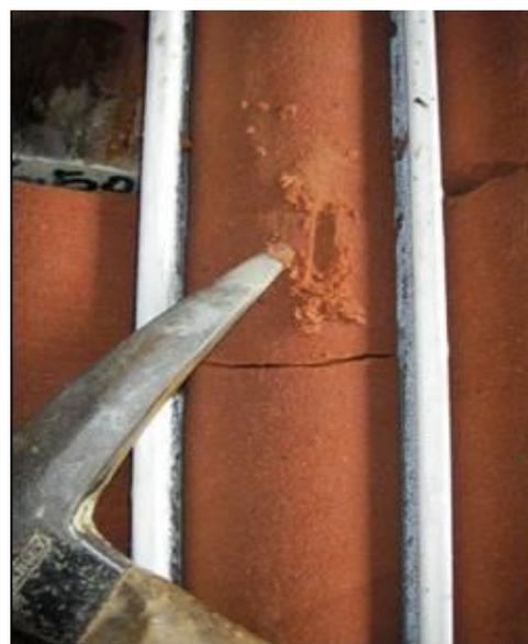
**Figura 6.2 – Arenito medianamente coerente (C2). O risco da ponta do martelo**
