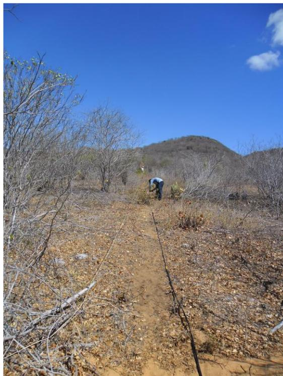
**Figura 5.20 - Membro da equipe estendendo o cabo sismográfico e acoplando os geofones.**
