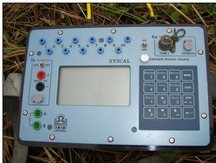
**Figura 5.11 - Syscal Switch Pro - Eletroresistivímetro digital multi-eletrodo utilizado durante a aquisição.**
